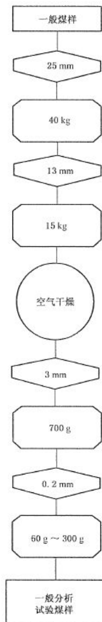
图 10 一般分析试验煤样制备程序示例
